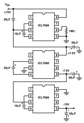
FIGURE 21. +15V TO -15V IN THREE EASY STAGES
