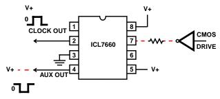
FIGURE 23. HIGH POWER CLOCK DRIVE
