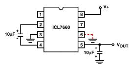
FIGURE 6. SIMPLE NEGATIVE CONVERTER
