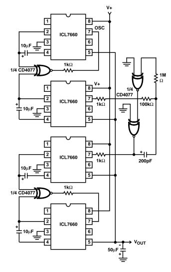
FIGURE 15. SYNCHRONIZING A QUAD
