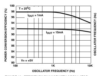
FIGURE 10. EFFICIENCY CHANGE WITH OSCILLATOR FREQUENCY
