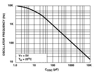
FIGURE 11. FREQUENCY VARIATION WITH OSCILLATOR CAPACITANCE
